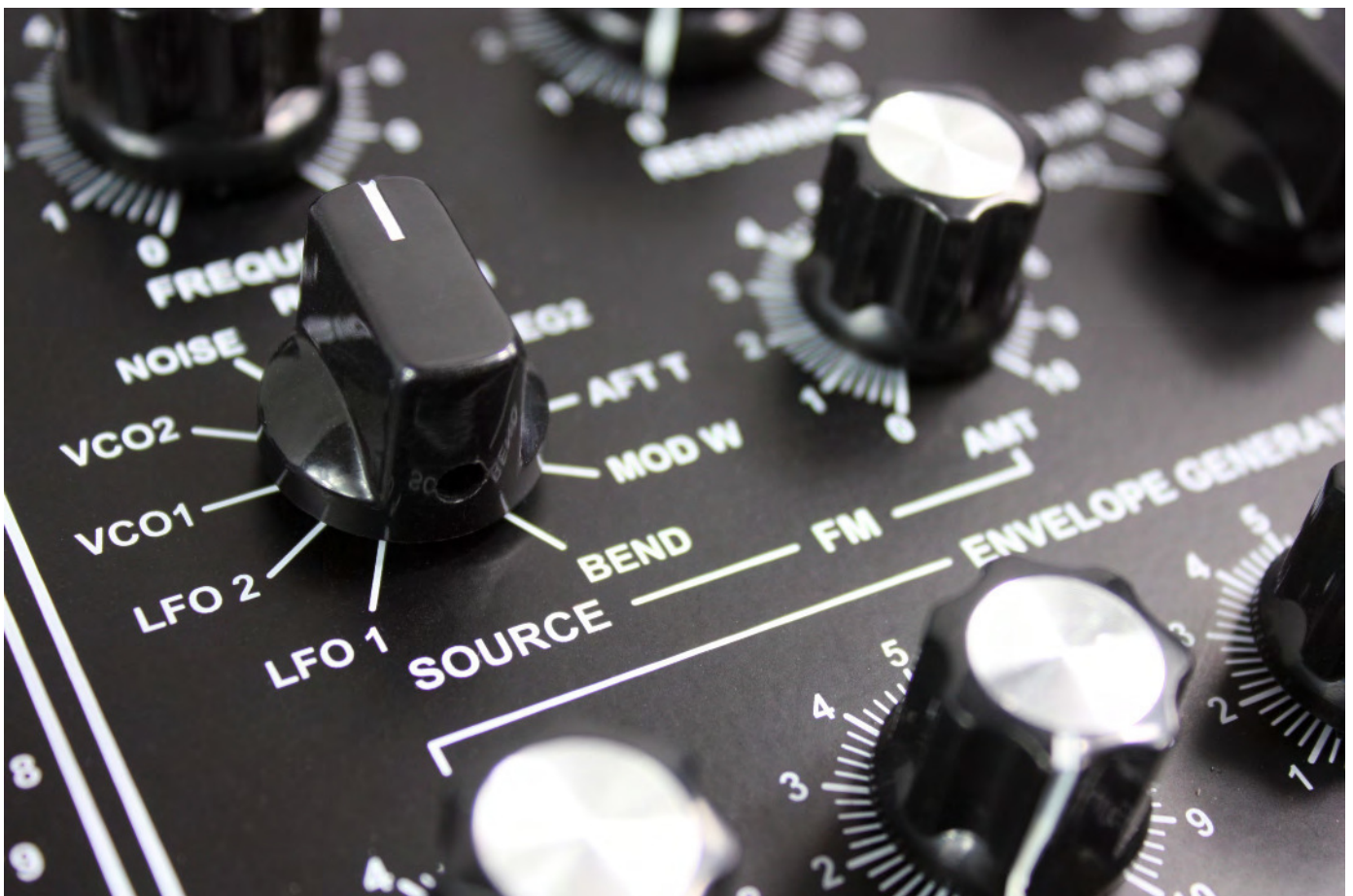
Besonderheit des A2: Wahlschalter für die Modulationsquellen in beiden VCOs und im Filter.
