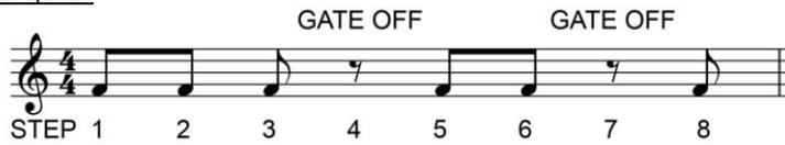
Die Schritte 4 und 7 haben GATE OFF und triggern den angeschlossenen Synthesizer nicht – es entstehen Pausen. Durch An/Abschalten von GATE kann man z.B. Sequenzen ganz einfach Stück für Stück aufbauen oder auch wieder abbauen oder nur Fragmente daraus abspielen, je nach Position der einzelnen GATE Schalter.
